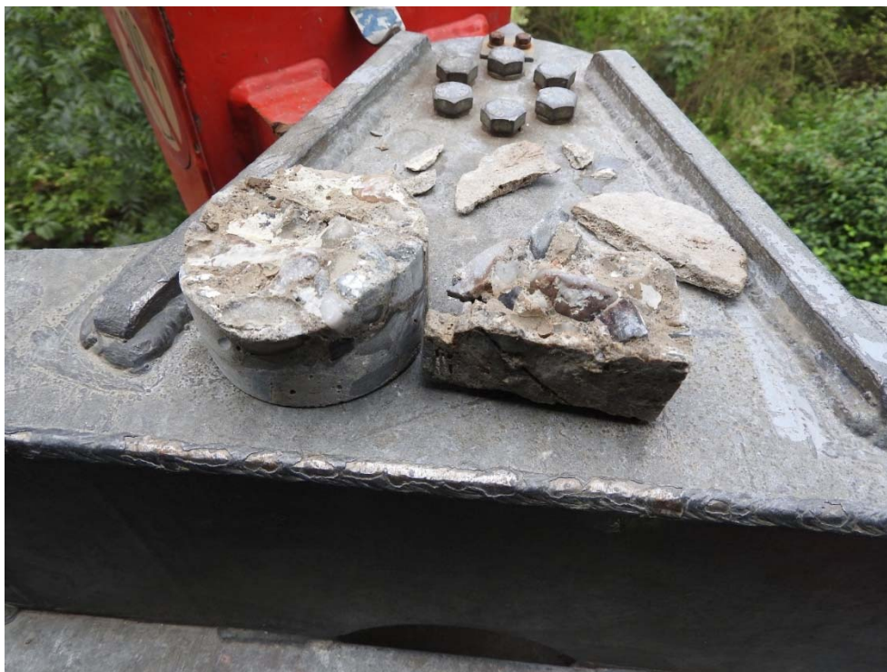
Obr. 6.9 Jádro z vrtu č. 2. Na povrchu vývrtu vlevo (plocha trhliny v konstrukci) je bílá vrstva – zřejmě výluhy pojiva
