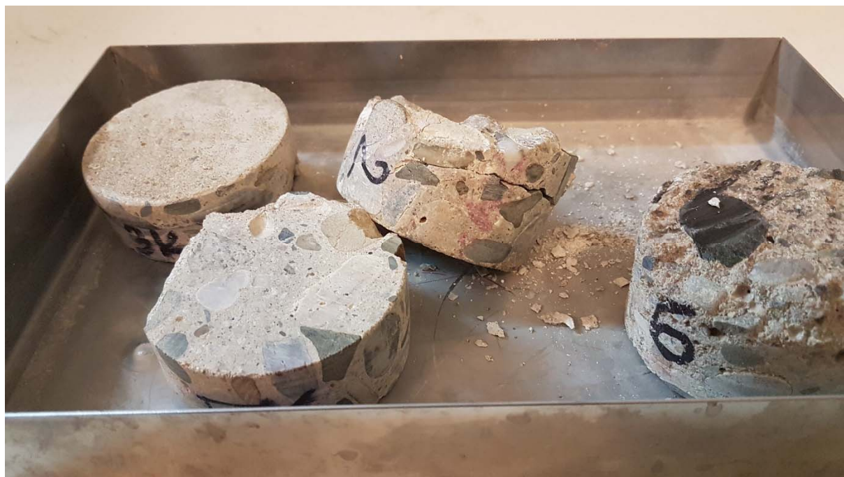
Obr. 6.29 Vzorky po zkoušce mrazuvzdornosti
