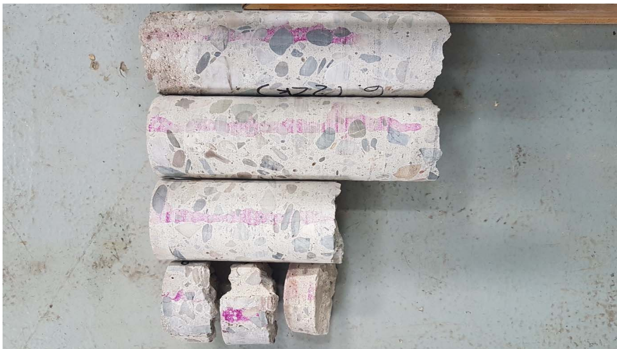
Obr. 6.28 Zjišťování úrovně karbonatace betonu
