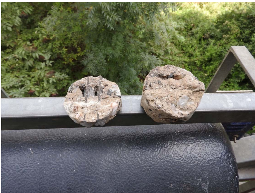
Obr. 6.5 Jádru z vrtu č. 1 rozdělené na dvě části
