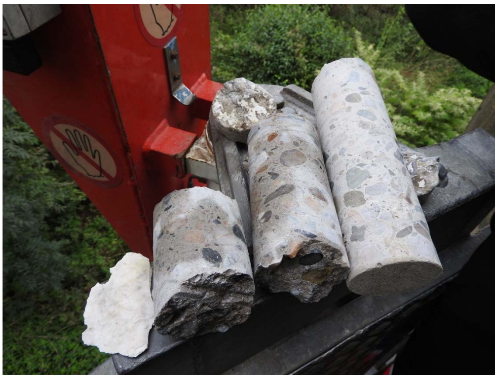
Obr. 6.10 Jádro z vrtu č. 3 (kratší části vlevo a uprostřed) a 4 (delší část vpravo)
