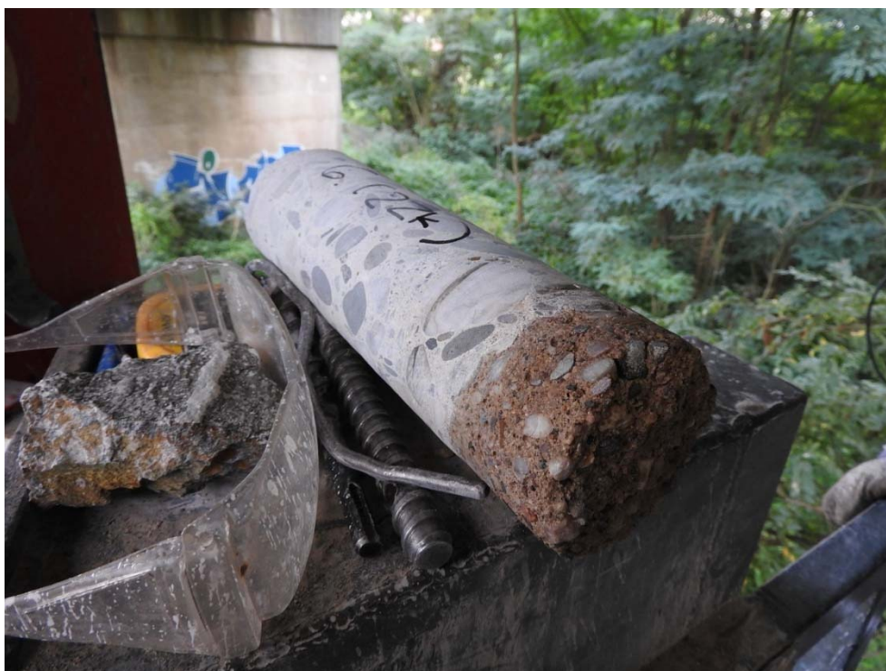
Obr. 6.18 Jádro z vrtu č. 6 – na povrchu je zdegradovaný beton v tl. cca 50 mm
